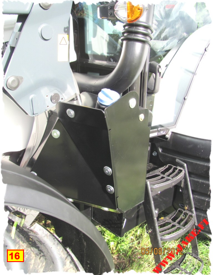
Ureatankin panssari kun etukuormain. AdBlue tank armour when front loader.
